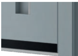
Trittschutz schwarz Höhe: 40 mm, - planflächig in das flügelabdeckende Türblatt eingelassen, Art. Nr. 255
