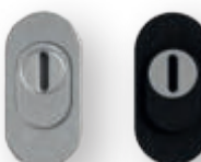
PZ-Sicherheitsrosette mit Kernziehschutz, einstellbar von 8 - 15 mm, 37 / 74 mm, Stärke 14 mm, Edelstahl matt: Art.-Nr. 1062-01 schwarz: Art.-Nr. 1062-03
